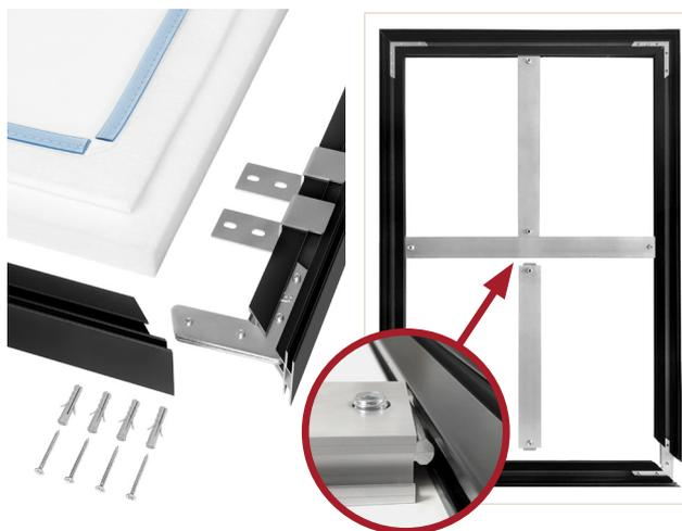
Un support ou une croix de stabilisation n'est inclus que dans les cadres de grande taille! Introduisez le(s) support(s) de stabilisation dans l'ouverture du cadre profilé. Veillez à ce que le verrou soit bien inséré dans la rainure intérieure. Serrez toutes les vis.
