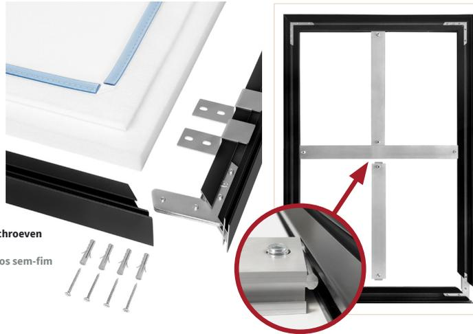
Een stabilisatiebalk of -kruis is alleen inbegrepen bij grote frames! Schroef de schroeven in de voormonteerde gaten van de kaderlijsten en plaats de stabiliserende lijst(en) op. Zorg ervoor dat de vergrendeling in de binnenste groef zit. Draai alle schroeven vast.
