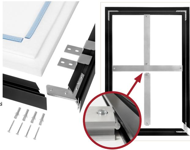
Un supporto o una croce di stabilizzazione sono inclusi solo nei frame di grandi dimensioni! Inserisci i supporti/il supporto di stabilizzazione nell'apertura del profilo del frame. Assicurati che il dispositivo di chiusura si trovi nella scanalatura interna. Stringi tutte le viti.
